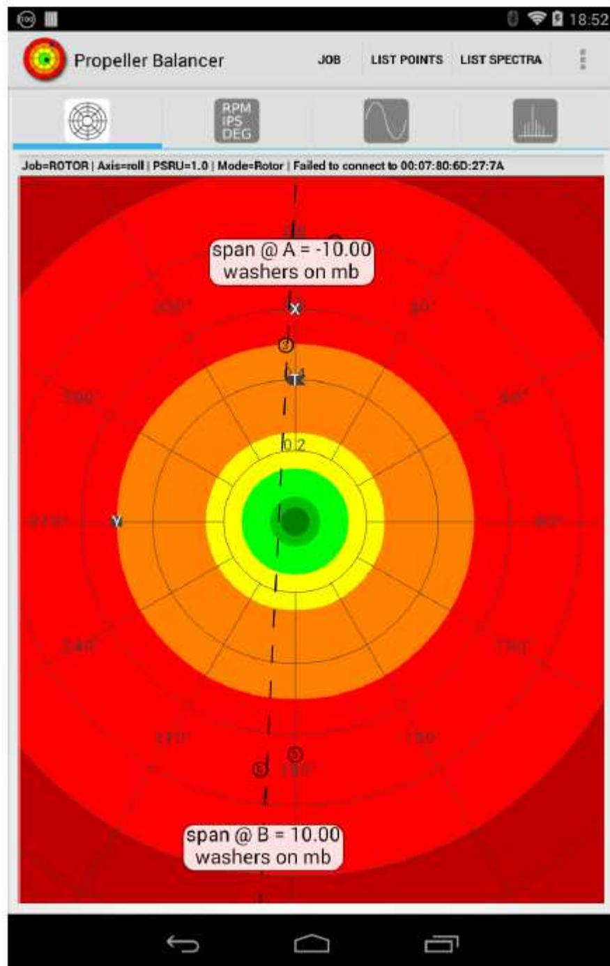
Fig. 2.5. Faire bouger un axe de réglage (move line)
